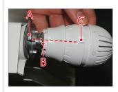
2) Enganchar el cabezal termostático a la válvula, verificando que los posicionadores de la válvula (A), la hendidura pequeña del cabezal termostático (B), y la línea indicadora (C), estén alineadas.
