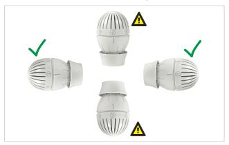
⚠ No se recomiendan estas posiciones de instalación debido a que la temperatura del radiador puede influir en el cabezal termostático.
