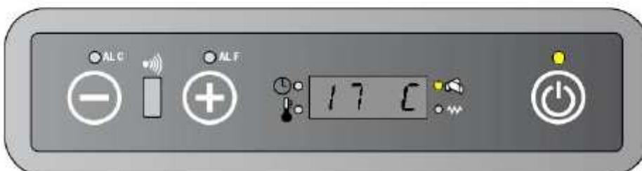
Si la temperatura ambiente supera la temperatura seleccionada ( $RT \geq SPT$ ) la estufa entra en modo ECO.
