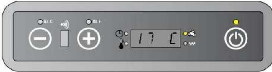
Si la temperatura ambiente supera la temperatura seleccionada, la estufa seguirá funcionando en modo TURBO. (no pasa a modo ECO).
