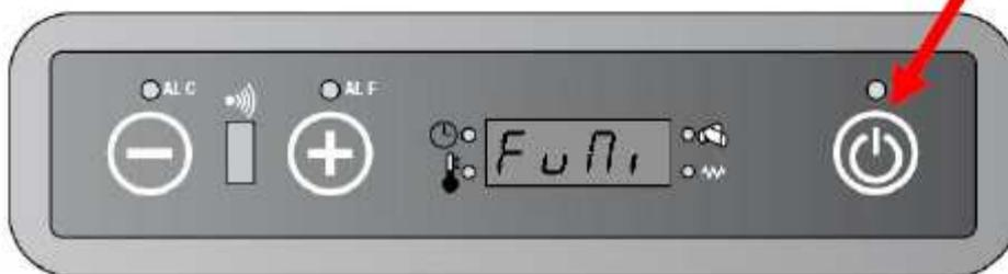
A través del mando a distancia: mantener pulsado on/off (+enviar) para resetear la alarma.
