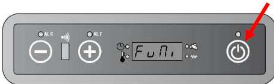
A través del mando a distancia: mantener pulsado on/off (+enviar) para resetear la alarma.
