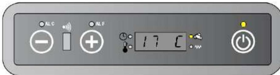
Si la temperatura ambiente alcanza o supera la temperatura seleccionada, ( $RT \geq SPT$ ) la unidad pasa a modo ECO. El led de temperatura ok se enciende.
