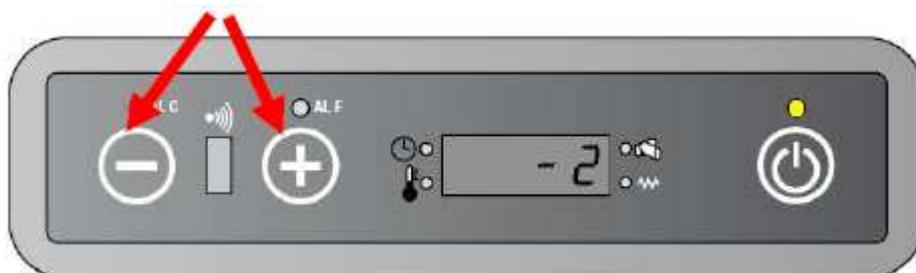
El rango de valor posible de Cpell y Casp está entre -5 y +5. Cada punto corresponde a una variación de +/- 5% sobre valor base. (PR06 – PR10 para carga de pellet; PR18 – PR22 para extractor de humo).
