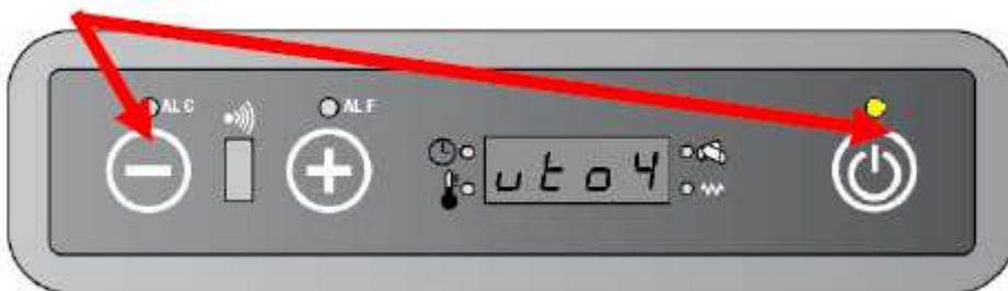
Pulsar repetidamente los botones 1 y 2 hasta visualizar A9 en el display. Mantener presionado para avanzar más rápido.
