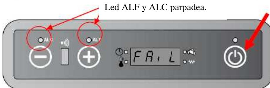
A través del mando a distancia: mantener pulsado on/off (+enviar) para resetear la alarma.
