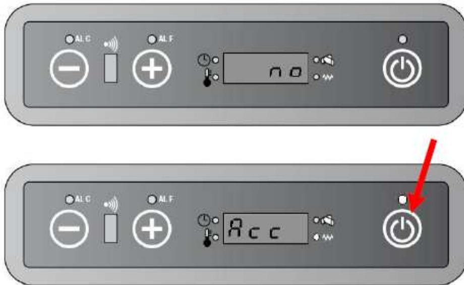
A través del mando a distancia: mantener pulsado on/off (+enviar) para resetear la alarma.
