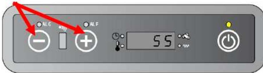
Presionar botón 3 para resetear las horas parciales de funcionamiento.
