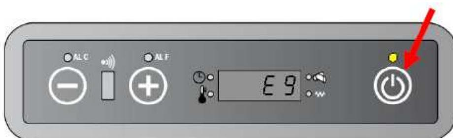
El display mostrará alternativamente el número de error y el tipo de alarma. Presionar nuevamente 3 para pasar de una alarma a otra.
