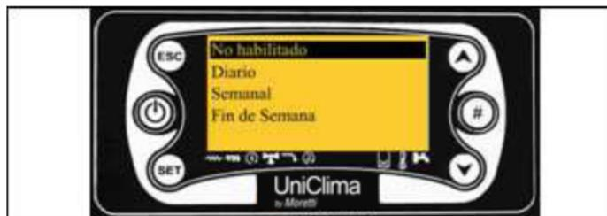
Entrar en modificación con la tecla P3, seleccionar el término deseado con las teclas **P4** y **P6**, memorizar la nueva configuración con la tecla **P3**, salir del menú con la tecla P1
