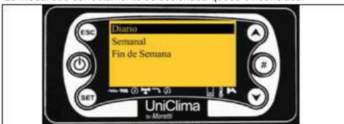
Entrar en modificación con la tecla P3, seleccionar el término deseado con las teclas P4 y P6, memorizar la nueva configuración con la tecla P3, salir del menú con la tecla P1
