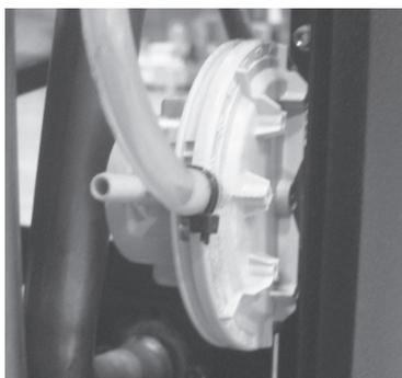
**Presostato:** controla la presión del conducto de humos. Se ocupa de bloquear la cónica de carga de las pellas en caso de que la descarga esté obstruida o de que haya contrapresiones significativas por ejemplo en presencia de viento. En el momento del interruptor de presión va a leer “**ALAR-DEP-FAIL**”.
