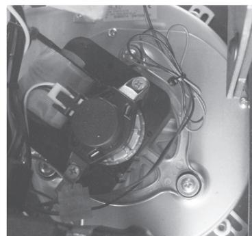
**Sensor temperatura humos:** termopar que mide la temperatura de los humos mientras se mantiene el funcionamiento o apaga la estufa cuando la temperatura del gas de combustión cae por debajo del valor preestablecido.
