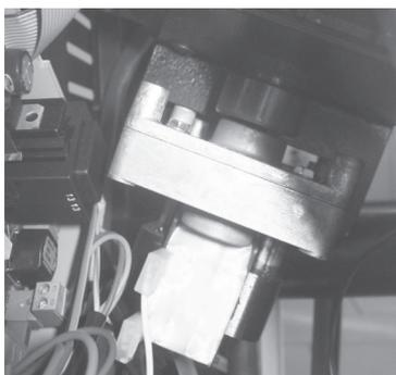
**Motorreductor:** si el motorreductor se detiene, la estufa sigue funcionando hasta que no se apaga la llama por falta de combustible y hasta alcanzar el nivel mínimo de enfriamiento.
